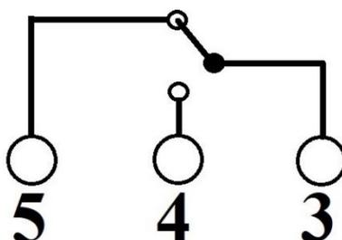
El temporizador cuenta con una salida relé, para el cual posee 3 terminales, el común (3), normal abierto (4) y normal cerrado (5). Además, se cuenta con un Led indicador, el cual se encarga de informar el estado de la salida.
