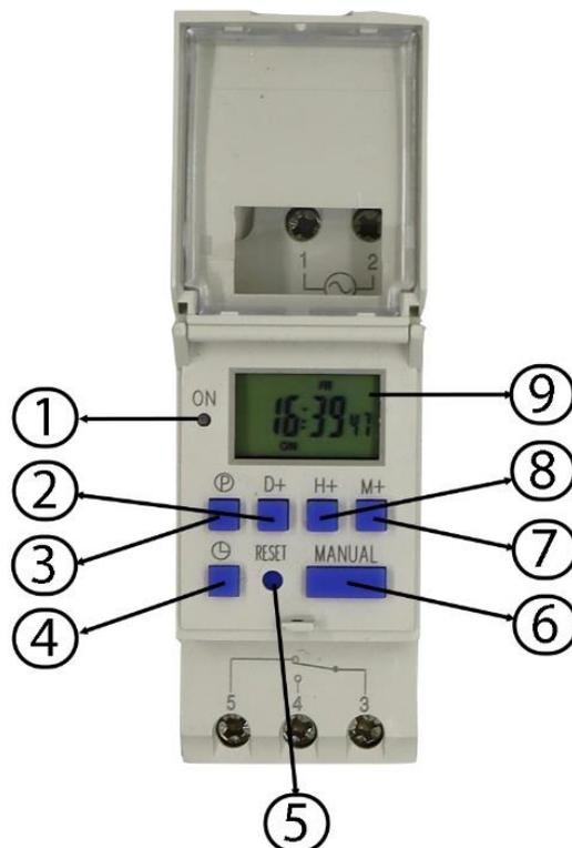
1. Led Indicador de activación de relay
