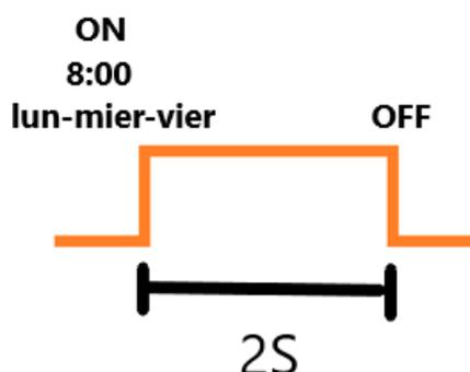
**Nota:** A pesar de no poder programarse un pulso con flanco negativo, es decir que pase de OFF a ON después de un tiempo preseado, si es posible obtener este resultado si se opera con la salida NC del relé.
